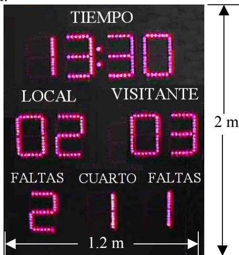
Figura 5: Tablero desplegado terminado
